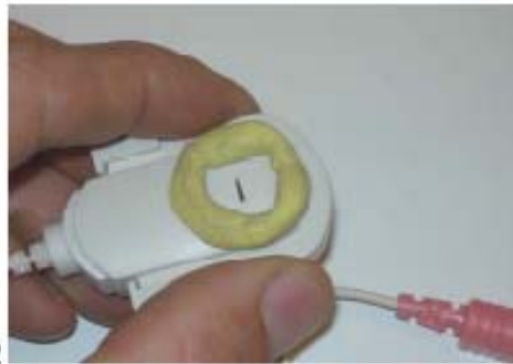
2 1 er boudin de gomme autour de la fente du microphone
